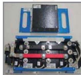
Das AC- System hat 3 Inverter, einen für den rechten Fahrmotor, einen für den linken Fahrmotor und einen für den Hydraulikmotor. Diese 3 Inverter Power Module wechseln den DC- Strom (Gleichstrom) in AC -Strom (Wechselstrom) um.
