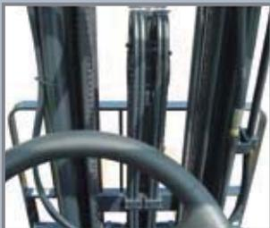
Durch neu verlegte Hydraulikschläuche ergibt sich eine verbesserte Durchsicht gegenüber dem alten Mast um ca. 15%
