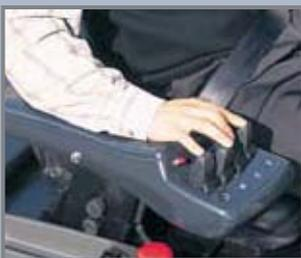
Finger- Tip Hydrauliksteuerventil
